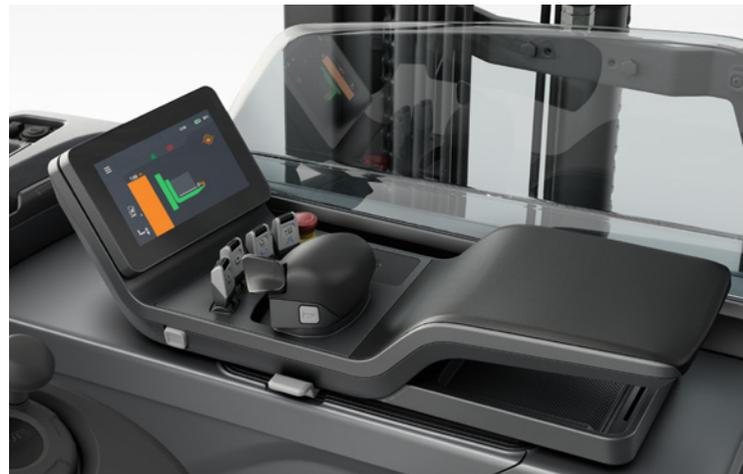
La console réglable à mini-leviers permet une commande précise du bout des doigts
