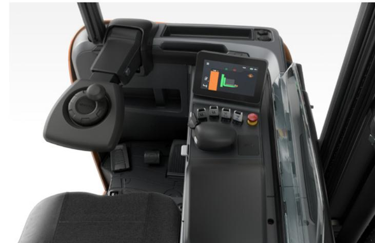
Le poste cariste offre divers espaces de rangement, ainsi qu'un emplacement réservé à un ordinateur portable avec prise de courant et connecteur USB
